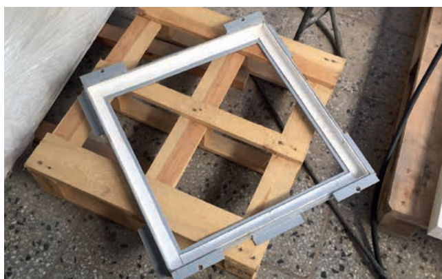
Nosný ocelový svařený rám s úhelníky.
